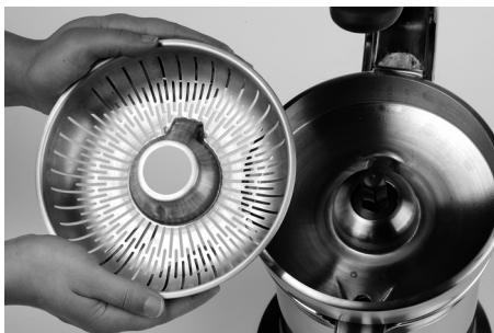
4. Załącz stożek wyciskarki na wał napędowy i lekko przyciśnij, aby zapadł na swoje miejsce.
