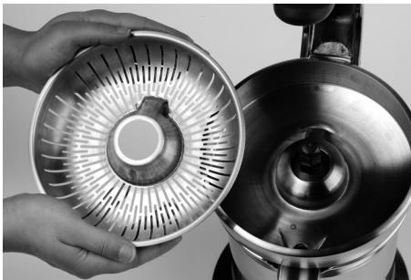
4. Lisovací trn nasadte na hnací hřídel a lehce přitlačte, aby zapadl na své místo.
