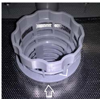
špatně zajištěný filtr
