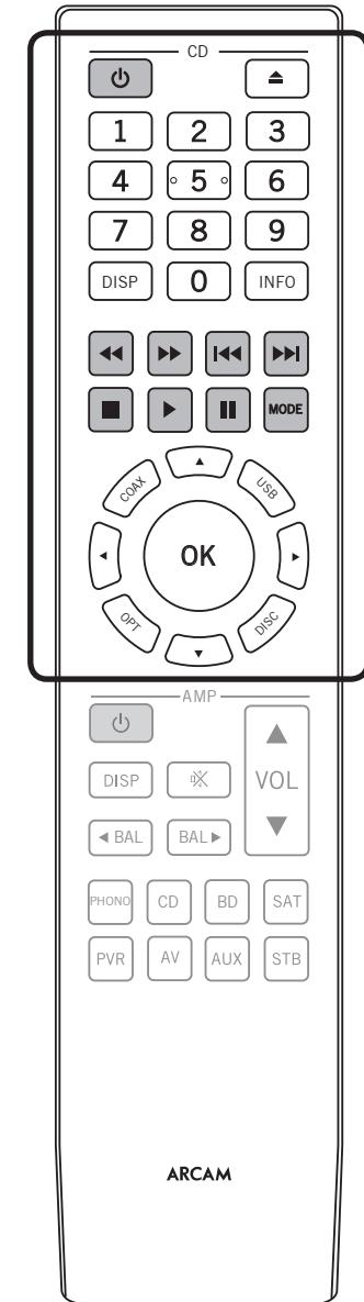
Die Fernbedienung ist für den Einsatz mit dem CDS50-Player und einem integrierten Arcam-Verstärker vorprogrammiert. Die Informationen in diesem Abschnitt gelten nur für den **CD**-Bereich der Fernbedienung.
